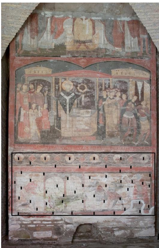
Εικόνα 3: Τοιχογραφία του 11ου αιώνα μ.Χ. στην Βασιλική του Αγίου Κλήμη στην Ρώμη. Επισημαίνονται τα σημεία όπου πραγματοποιήθηκαν in situ μετρήσεις NMR, με σκοπό την ποσοτική χαρτογράφηση της τριχοειδούς υγρασίας.
