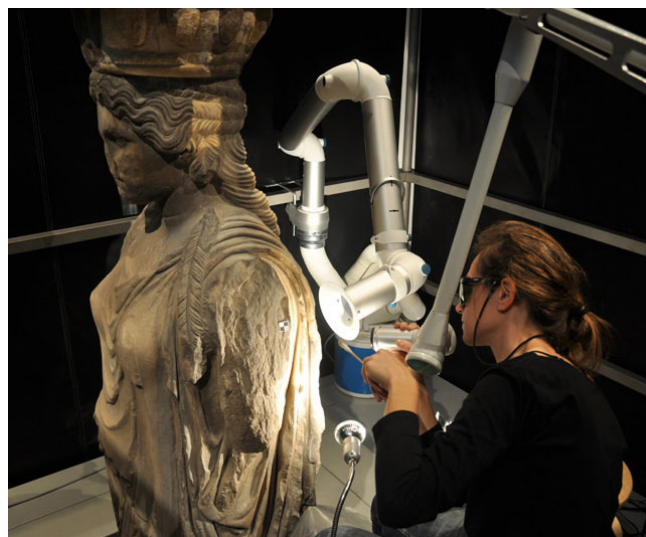
Εικόνα 1: Εφαρμογή πρωτότυπου συστήματος laser, που αναπτύχθηκε από το Ίδρυμα Τεχνολογίας και Έρευνας Κρήτης, στο πλαίσιο προγράμματος καθαρισμού των γλυπτών του Μουσείου Ακρόπολης από τις επικαθίσεις ατμοσφαιρικών ρύπων.
