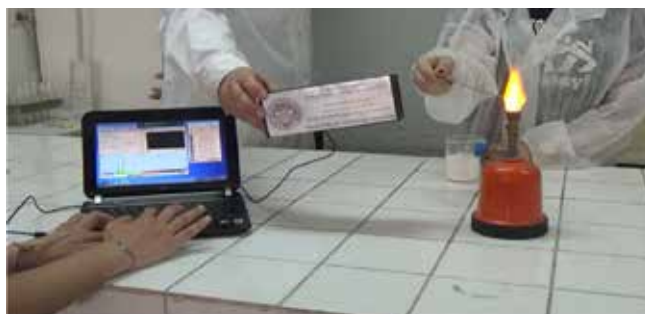
Εικόνα 2: Το φασματοφωτόμετρο σε λειτουργία. Διακρίνεται το κίτρινο χαρακτηριστικό χρώμα του νατρίου στη φλόγα.
