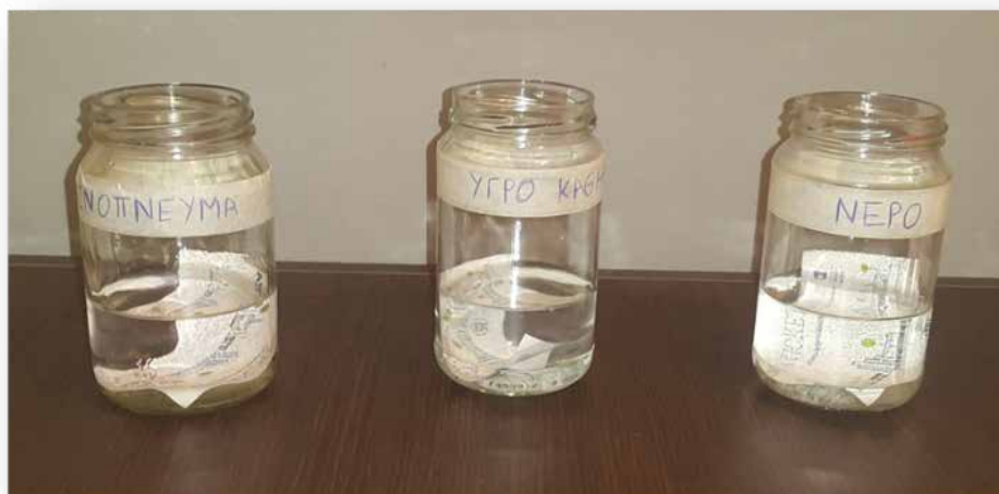
Εικόνα 2. Τοποθέτηση των χάρτινων ηλεκτρονικών εισιτηρίων στα υγρά διαχωρισμού: οινόπνευμα, αιθερικό διάλυμα, νερό
